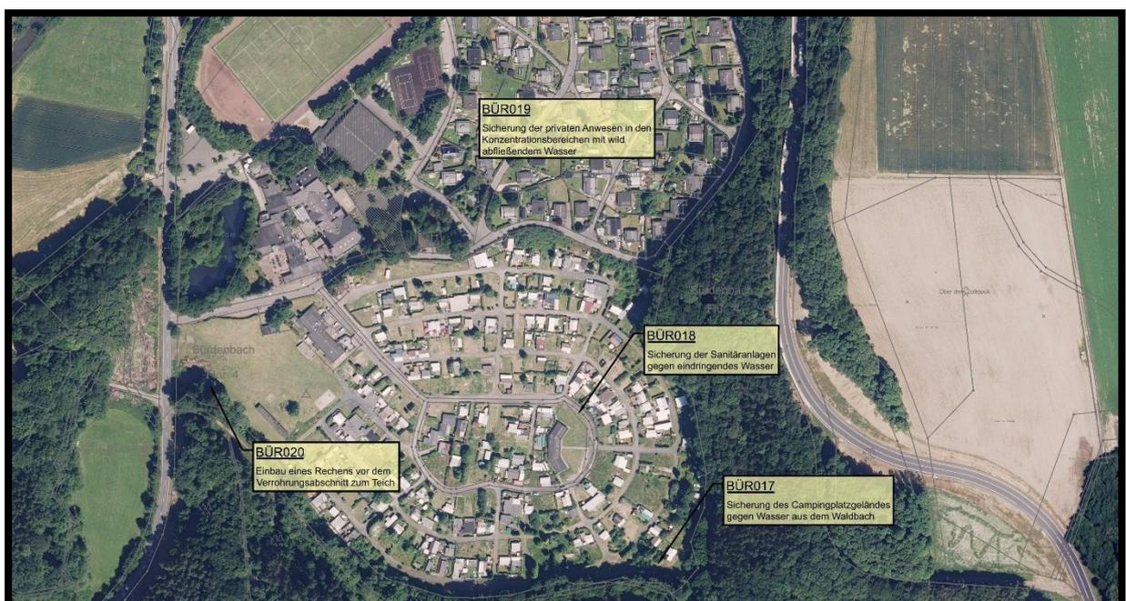
An der Bruchermühle sind die tief liegenden Gebäudeteile bei Hochwasser gegen eindringendes Wasser aus Wied und Werkgraben zu sichern.
