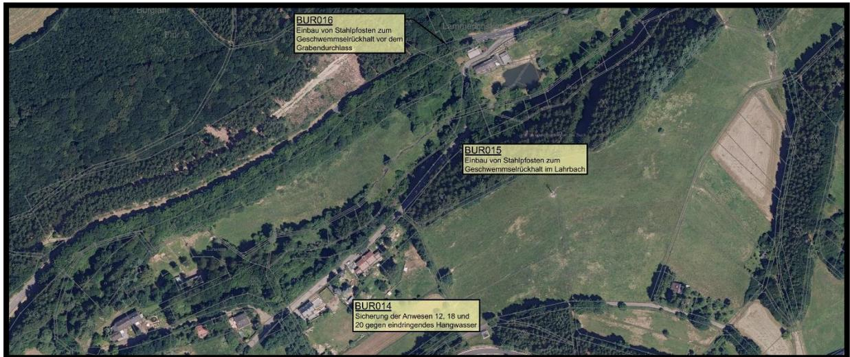
Im Bereich Grube Louise sind die oben angesprochenen Anwesen gegen Eindringen von Wasser auf der Rückseite der Häuser zu sichern. Im Lahrbach sind Stahlpfosten zum Geschwemmselrückhalt vor dem Durchlass unter der Bergstraße einzurammen. Dies gilt gleichermaßen für den Durchlass unter der K 3 für den von Norden zufließenden Graben.
