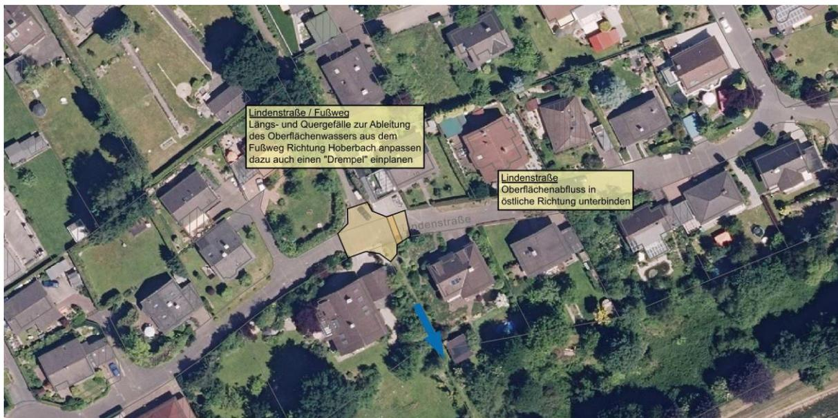
Zur Abfluslenkung für das Oberflächenwasser aus dem Fußweg ist der Einmündungsbereich in Längs- und Quergefälle so anzupassen, dass der Abfluss über den südlich verlaufenden Fußweg zum Hoberbach geleitet werden kann. Hier ist, ähnlich wie in der „Eichenstraße“, ein Drempel einzuplanen.
