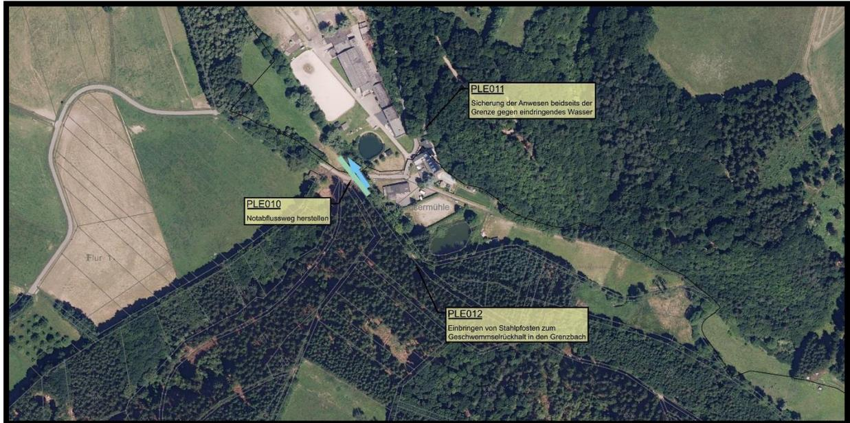
Zur Abwehr der Sturzfluten im Bereich der Pleckhauser Mühle ist ein Notabflussweg entlang der Brücke herzustellen und es sind Stahlpfosten im Grenzbach zum Rückhalt für Geschwemmsel an geeigneter Stelle einzubringen. Eigensicherung ist hier dennoch für die Anwesen beidseits der Kreisgrenze angeraten.
