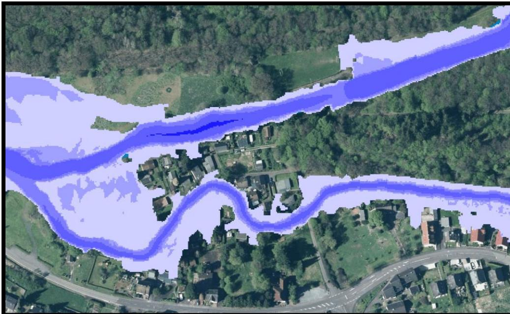
Flachwiesen, Wasserspiegellage bei  $HQ_{\text{extrem}}$
