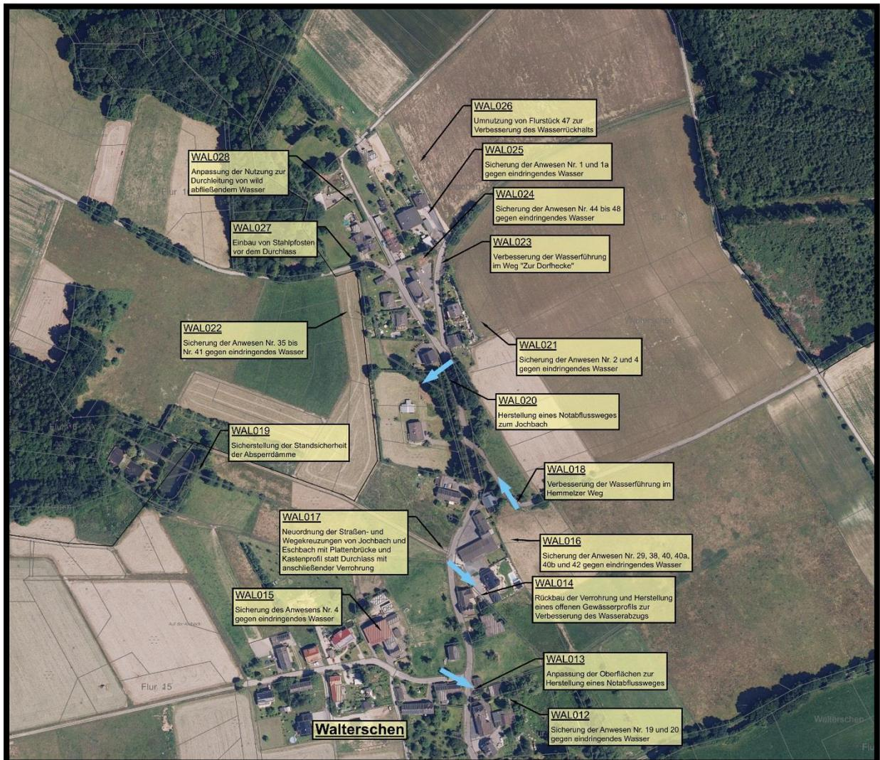
Die Verrohrungsstrecke des Jochbachs unterstrom der Einmündung des Eschbachs lässt sich für eine Sturzflut nach Starkregen nicht ertüchtigen. Hier ist der Rückbau angeraten und trotz der beengten Verhältnisse, die Herstellung eines natürlichen, offenen Bachlaufs vorzusehen.
