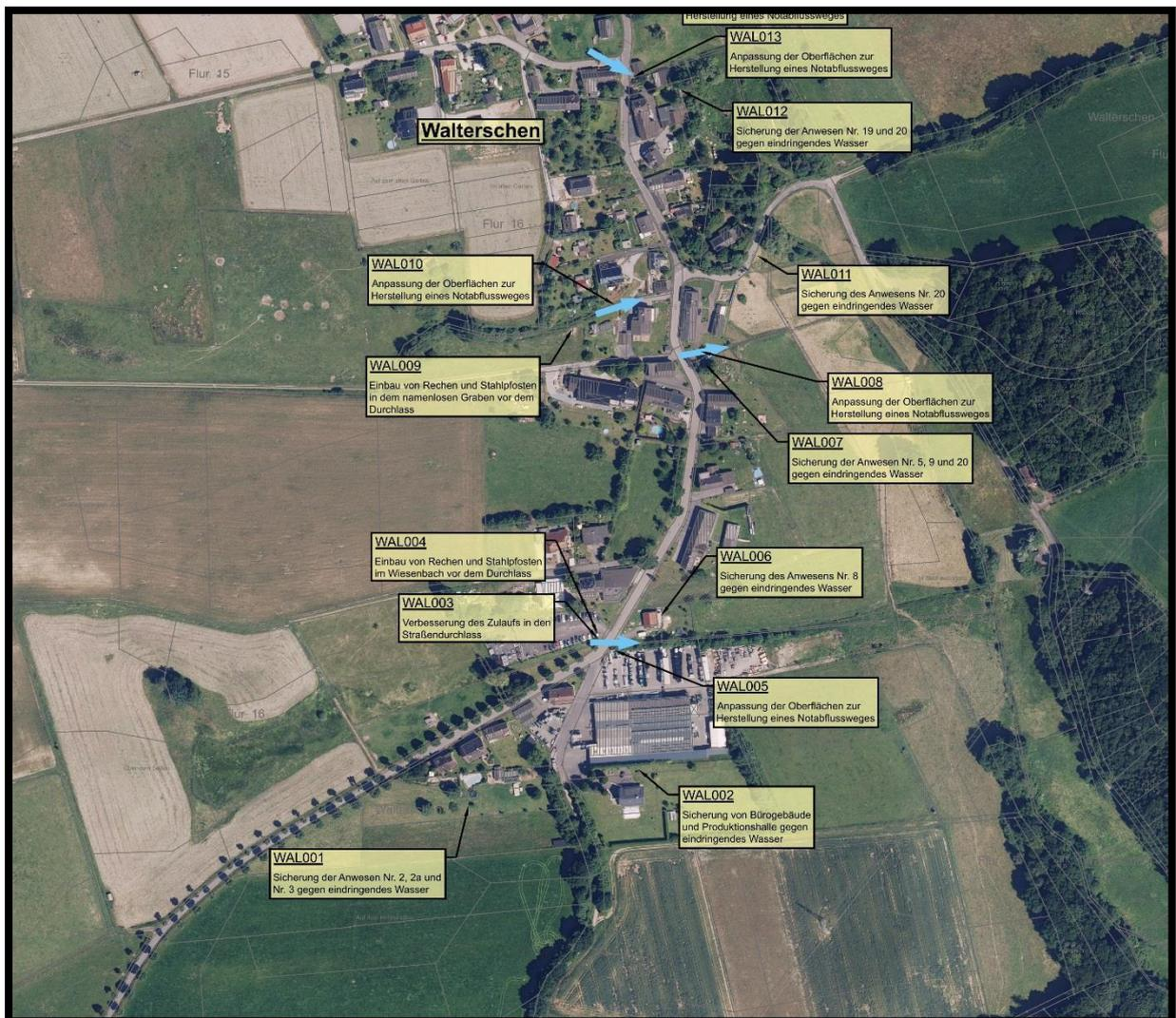
Der wiederum nördlich direkt angrenzende Graben wird in einem Kanal auf einer Länge von ca. 140 Metern, Straßenentwässerung inklusive, dem Jochbach zugeleitet. Von privater Seite wurde hier ein Einlaufbauwerk errichtet, welches durch ein geeignetes Bauwerk zu ersetzen ist. Notüberlauf und Notabflus-
